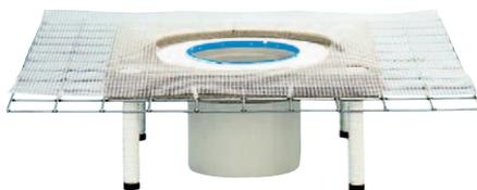
Elemento de elevación CeraDrain S 15 con cuello de hormigón polímero con malla de acero para macizar con la obra, tuercas niveladoras
